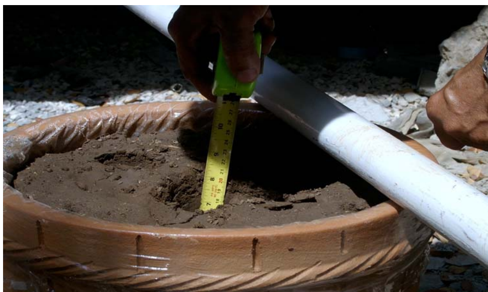
ภาพผนวกที่ ข3 การเจาะนำในดินที่ความลึกต่างๆ
