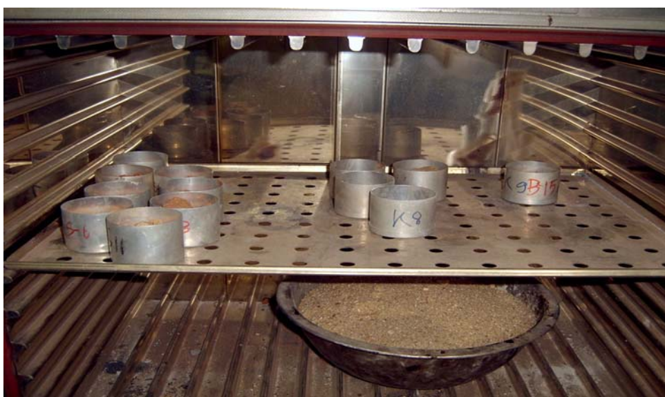
ภาพผนวกที่ ข10 การอบดินตัวอย่างเพื่อหาความชื้นโดยน้ำหนัก
