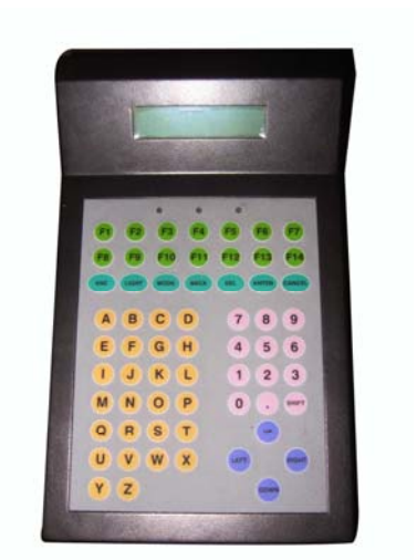
ภาพที่ 11 ตัวแปลงสัญญาณ พร้อมส่วนแสดงผลและจัดเก็บบันทึกข้อมูล
