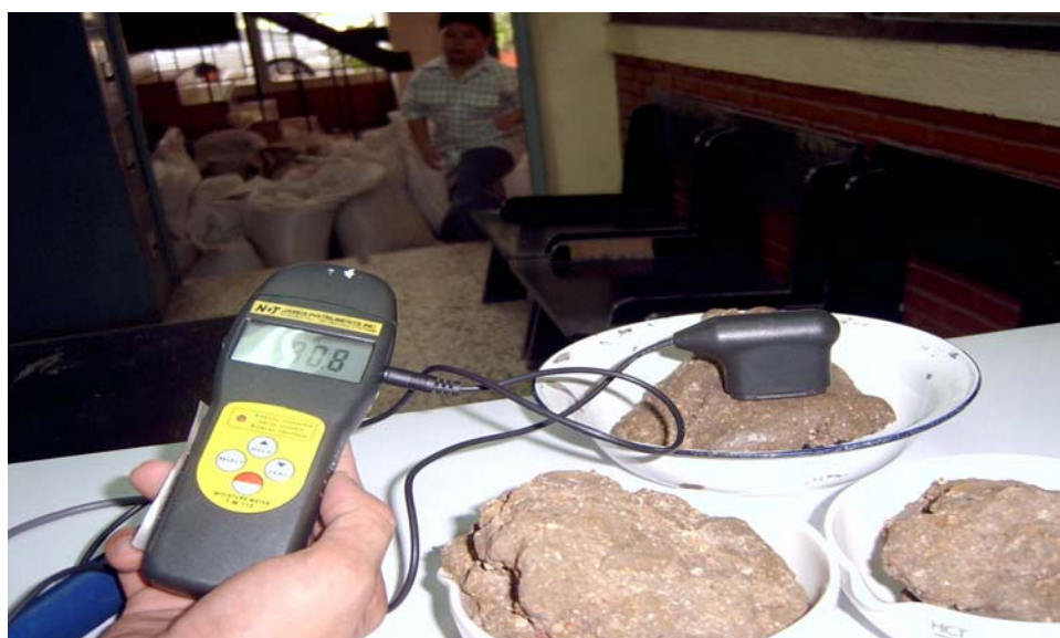
ภาพผนวกที่ ข8 การวัดความชื้นในดินเหนียวโดยเครื่องมือที่สร้างขึ้นกับเครื่องมืออ้างอิง
