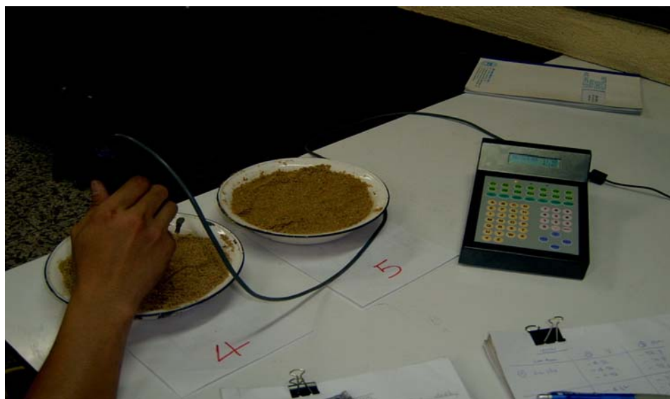
ภาพผนวกที่ ข6 การวัดความชื้นในดินทรายเพื่อสอบเทียบเครื่องมือ
