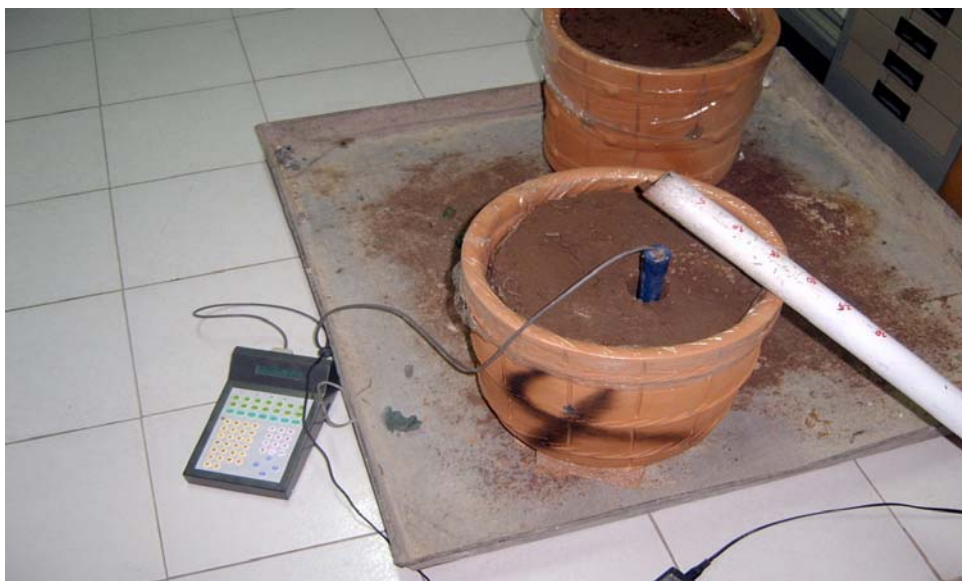
ภาพผนวกที่ ข4 การวัดความชื้นในดินที่ระดับความลึกต่างๆ
