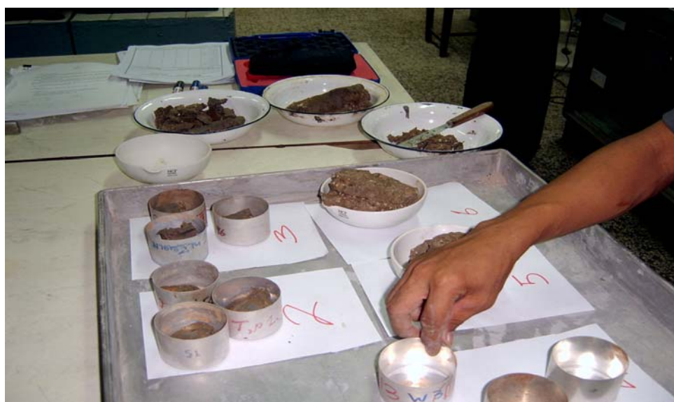
ภาพผนวกที่ ข9 การหาความชื้นในดินโดยน้ำหนักเพื่อสอบเทียบเครื่องมือ
