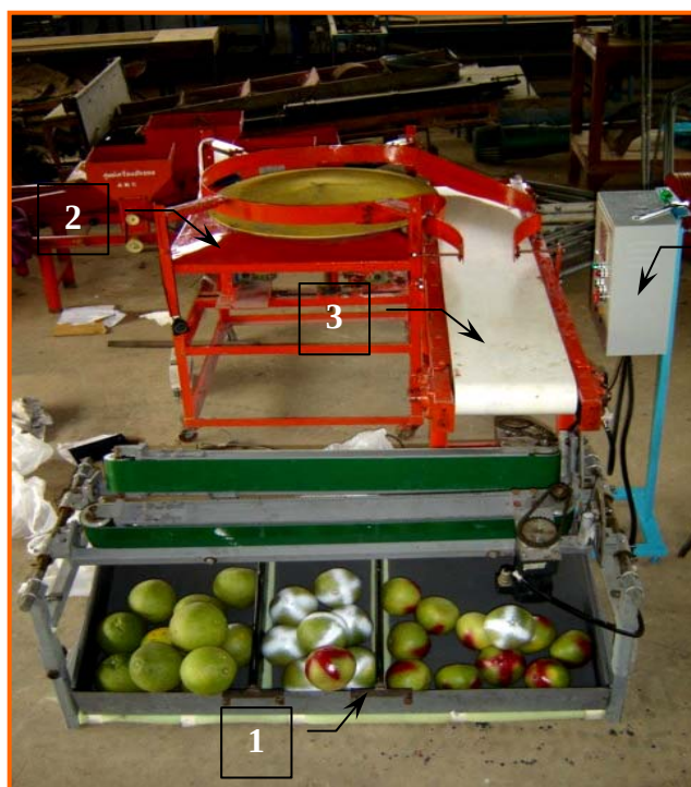
(1= เครื่องคัดขนาดผลส้มโอ 2 = เครื่องป้อนผลส้มโอ 3 = สายพานลำเลียง 4 = ตู้คอนโทรล)
