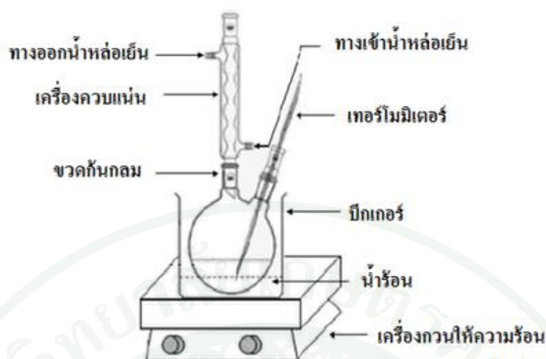
ภาพที่ 15 แผนภาพอุปกรณ์ที่ใช้ในการทดลองผลิตไบโอดีเซลด้วยเครื่องปฏิกรณ์แบบกะ
