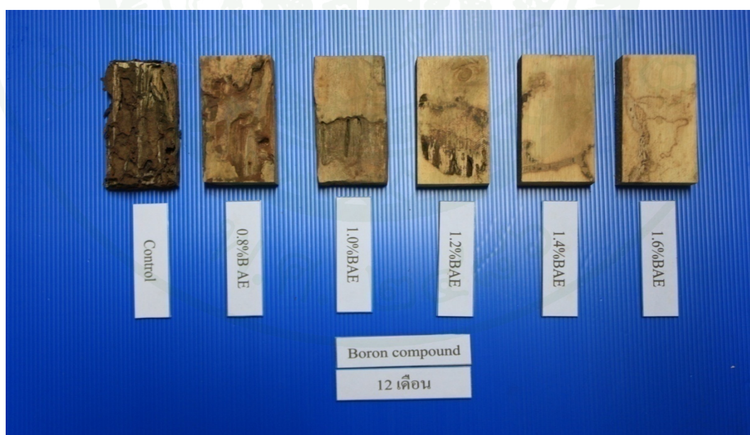
ภาพที่ 10 แสดงสภาพไม้ทดลองชุดเปรียบเทียบ (Control) และไม้ทดลองที่อัดด้วยสารประกอบโบรอน ภายหลังการทดลองในสภาพธรรมชาติ โดยปราศจากการชะล้างด้วยน้ำ เป็นระยะเวลา 1 ปี
