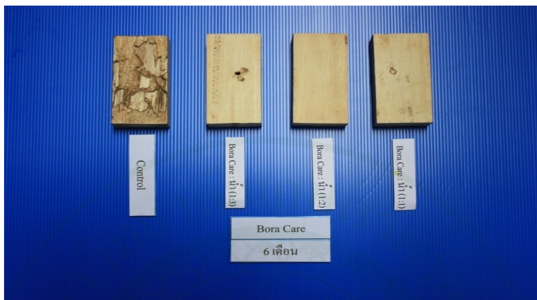
ภาพที่ 11 แสดงสภาพไม้ทดลองชุดเปรียบเทียบ (Control) และไม้ทดลองที่ทำด้วยสารบอราแคร์ ภายหลังการทดลองในสภาพธรรมชาติ โดยปราศจากการชะล้างด้วยน้ำ เป็นระยะเวลา 6 เดือน
