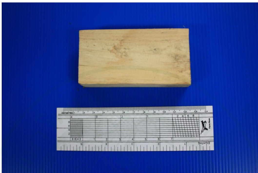
ภาพที่ 2 แสดงชิ้นไม้ทดลองยางพารา
