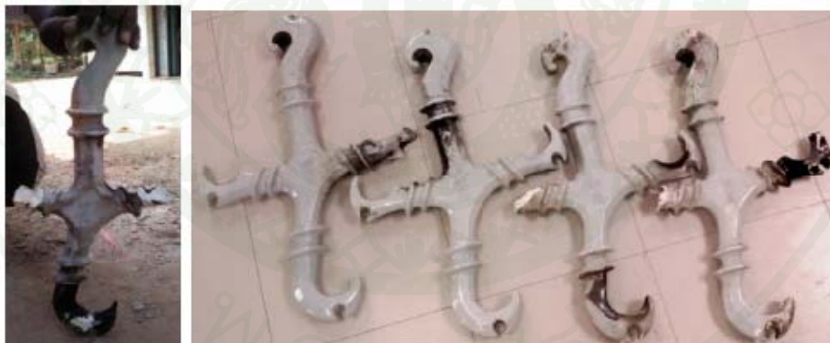
ภาพที่ 12 ลักษณะการชำรุดของ Porcelain spacer เคทีอบเซรามิก
