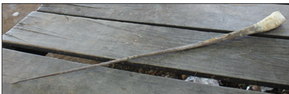
ภาพที่ ๑๔: รูปทางกระเบน เครื่องมือหนึ่งที่ใช้ในการทำปี่กาหยก
