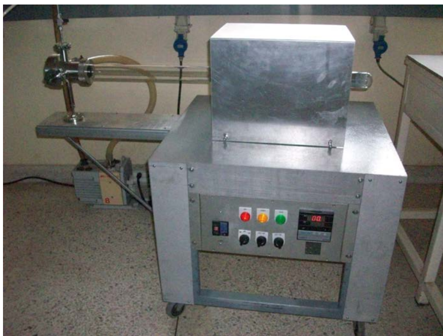
รูป 3.2 ชุดทดลองเตาท่อเผาสุญญากาศความดันประมาณ 10^{-2} - 10^{-3} mbar
