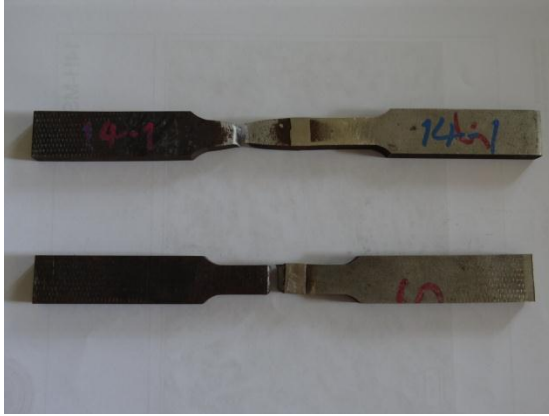
รูปที่ ข.7 ชิ้นงานที่ทดสอบแรงดึงมีค่าสูงสุด-ต่ำสุด
