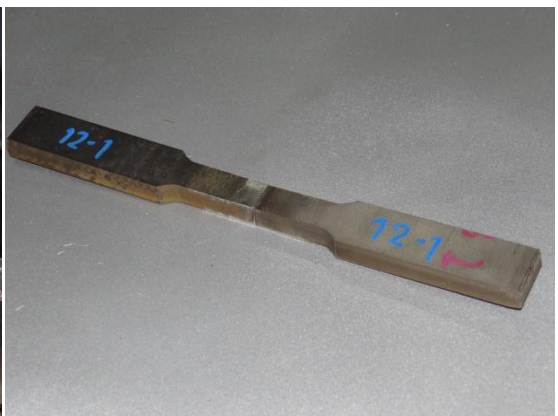
รูปที่ ข.6 ชิ้นงานที่กัดเสร็จแล้วเตรียมทดสอบ
