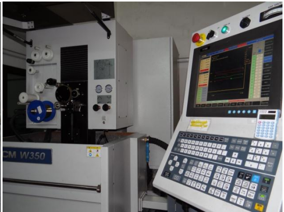
รูปที่ ข.4 ใช้เครื่อง wire cut ตัดทำชิ้นทดสอบ
