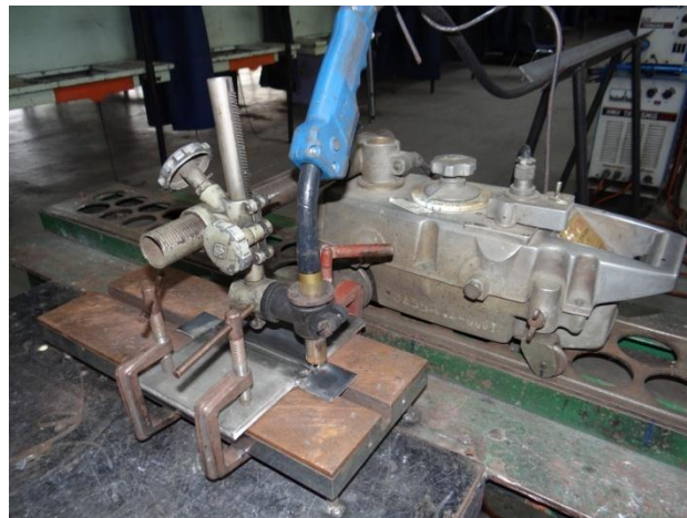
รูปที่ 3.2 เครื่องตัดแก๊สแบบเส้นตรงขับเคลื่อนด้วยมอเตอร์ประกอบกับหัวเชื่อม
