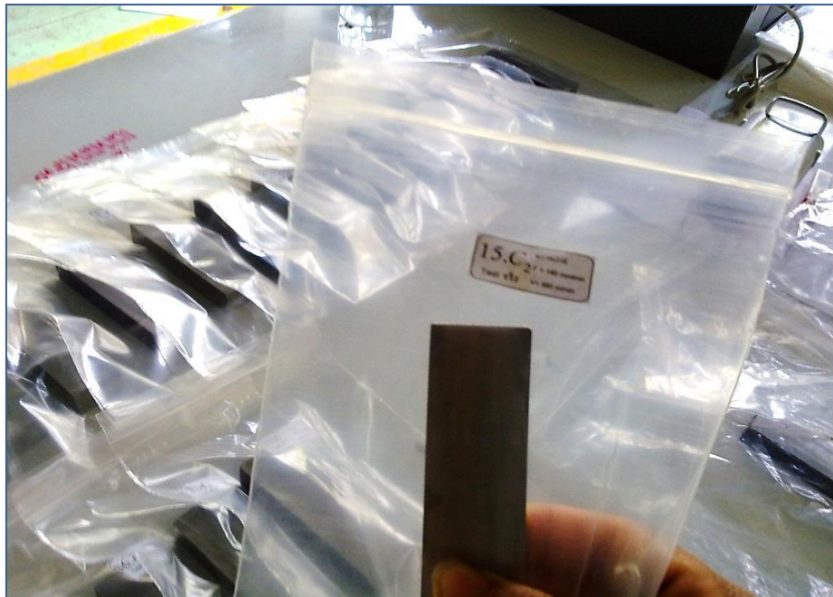
รูปที่ ค.14 ชิ้นงานที่ผ่านการทดลองจะลงรหัสสำหรับการทดลองและบรรจุถุงแต่ละชิ้น
