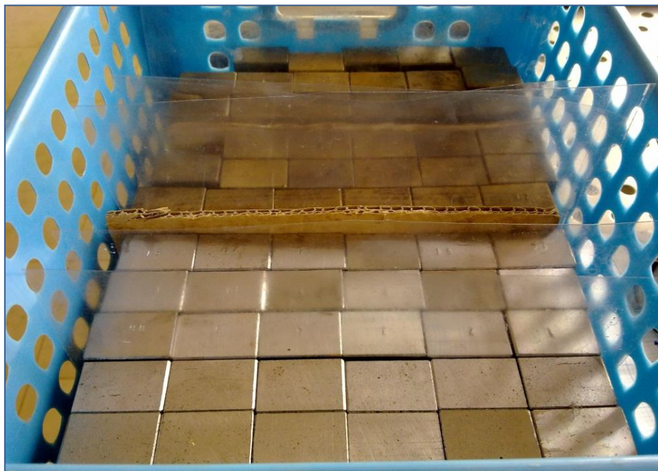
รูปที่ ค.4 ชิ้นงานที่ผ่านการอบด้วยความร้อนประกอบด้วย Annealing 1 ชุด Normalizing 18 ชุด และไม่ผ่านการอบ 18 ชุด
