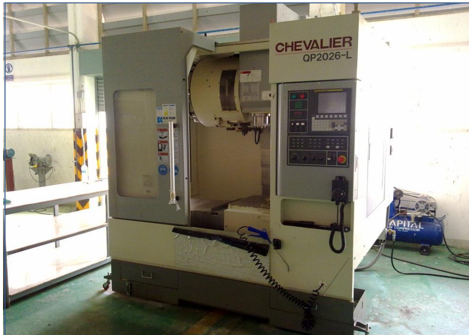
รูปที่ ค.11 เครื่องกัดที่ใช้ในการทดลองตัวแปร การศึกษาความเรียบผิวในการกัดเหล็ก AISI 1045
