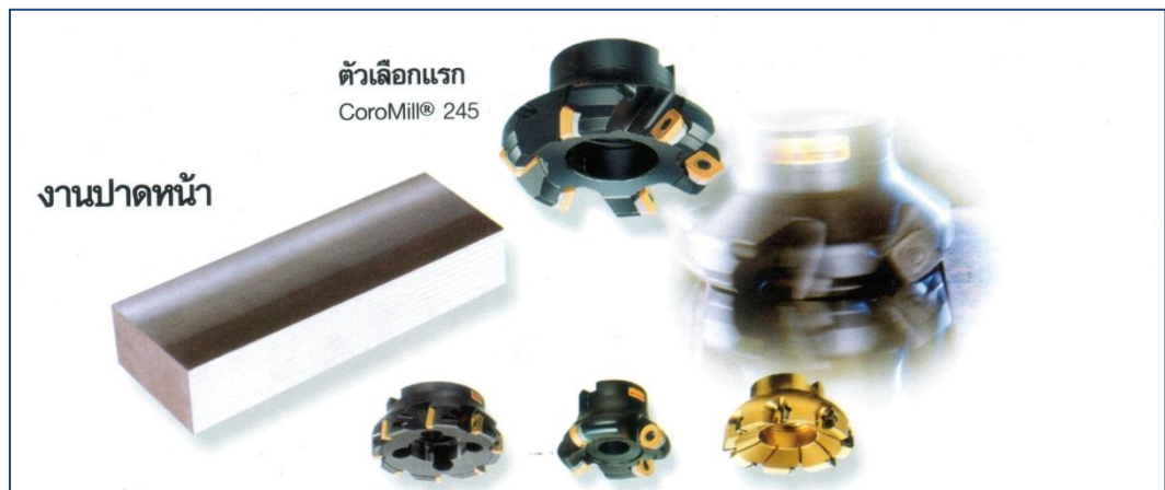
รูปที่ 2.18 ตัวอย่างของเฟซมิลล์สำหรับปาดผิวชิ้นงาน
