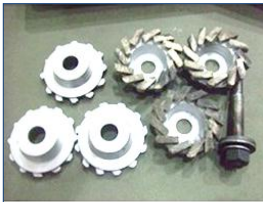
รูปที่ 2.23 วัสดุคมตัดแบบเพชร
