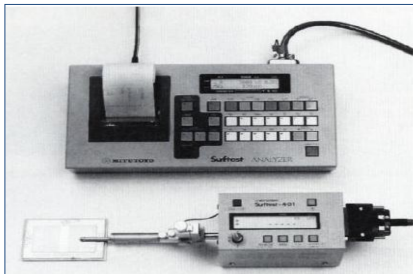
รูปที่ 2.15 เครื่องมือวัดค่าความหยาบผิวงาน
