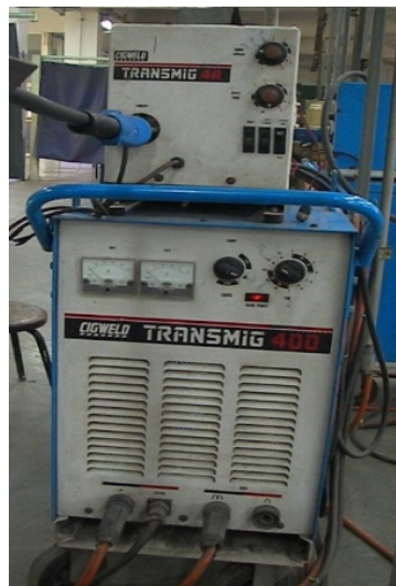
รูปที่ 3.2 เครื่องเชื่อม CIGWELD รุ่น TRANSMIG 400
