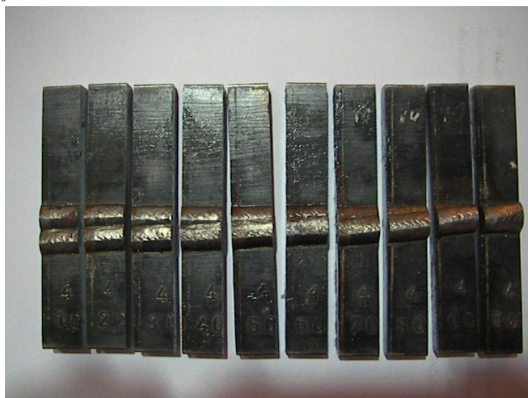
รูปที่ 3.14 ชิ้นงานที่ตัดด้วยเครื่อง Weir Cut
