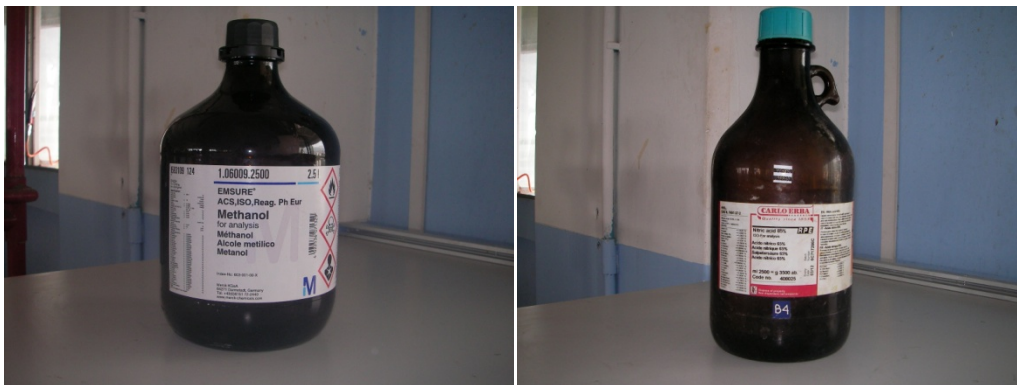
รูปที่ 3.18 แสดงสารเคมีที่ใช้ในการกัดผิวหน้าชิ้นงาน
