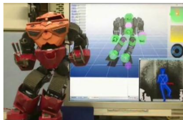
รูปที่ 2.11 การควบคุม Humanoid Robot ผ่านทางกล้อง Kinect [33]
