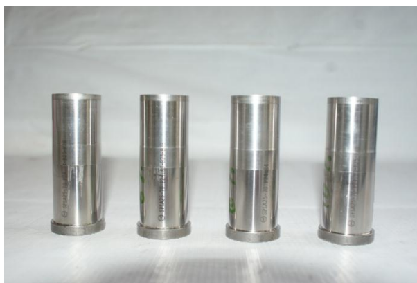
รูปที่ 3.1 ฟันซ์ ที่ใช้ในการตัดวัสดุงาน 4 ตัว
