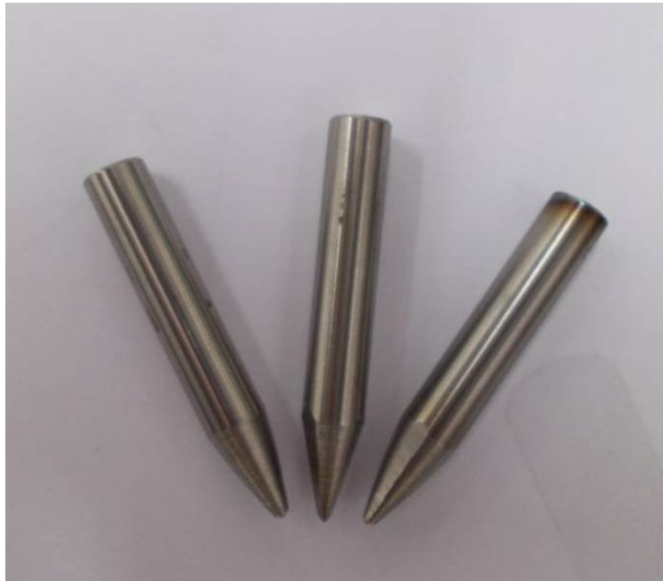
รูปที่ ค.5 เตรียมดอกเจาะ High Speed Steel (HSS) แท่งกลม เกรด 1900 ขนาดเส้นผ่าศูนย์กลาง 8 มิลลิเมตร ด้วยการลับเป็นรูปกรวยมุม 30 องศา และลับพื้นที่ผิวสัมผัสแรงเสียดทาน ที่ 50 % ,75% และ 100%
