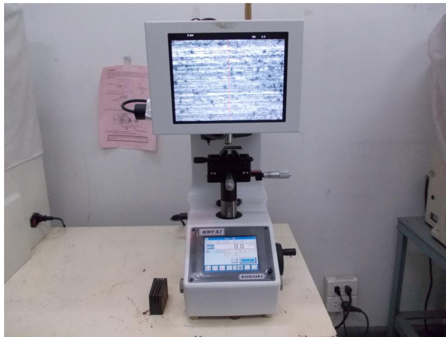
รูปที่ ค.2 นำชิ้นงานทดลองไปทดสอบหาค่าความแข็งแบบวิกเกอร์ส (HV)
