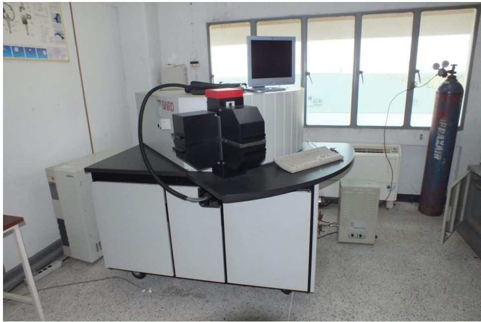
รูปที่ ค.3 ทดสอบหาค่าส่วนผสมของชิ้นงาน
