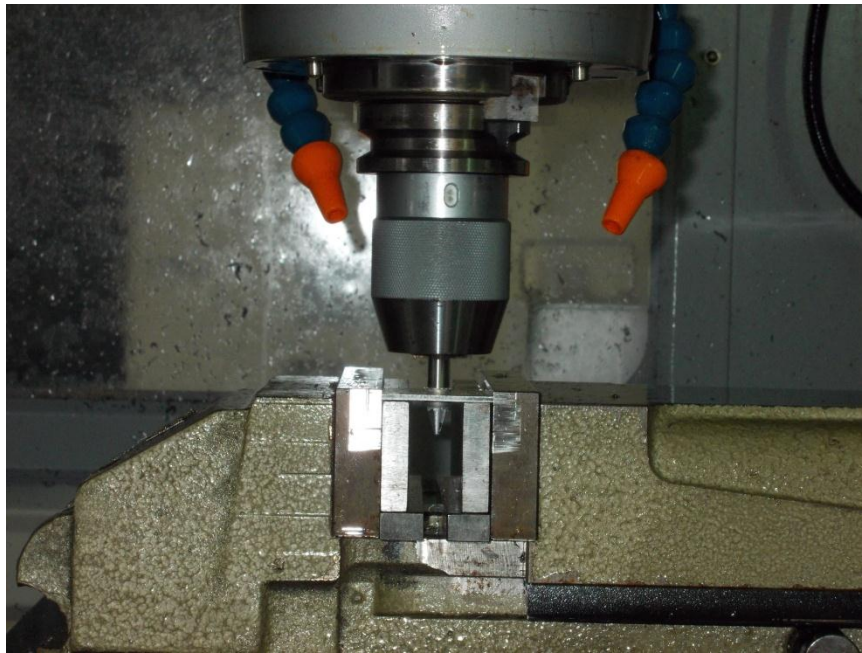
รูปที่ ค.7 เจาะชิ้นงานตามที่ได้ออกแบบการทดลองไว้
