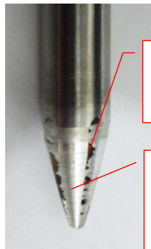
รูปที่ ค.14 ดอก HSS ขนาด 8 มม. ก่อนเจาะวัสดุ รูปที่ ค.15 ดอก HSS ขนาด 8 มม. หลังเจาะวัสดุ
