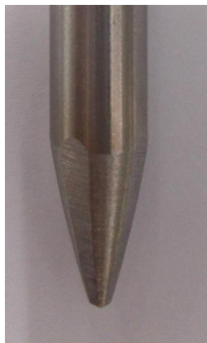
รูปที่ ค.14 ดอก HSS ขนาด 8 มม. ก่อนเจาะวัสดุ รูปที่ ค.15 ดอก HSS ขนาด 8 มม. หลังเจาะวัสดุ
