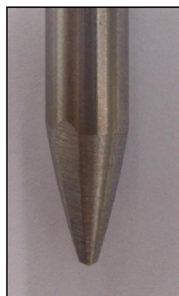
รูปที่ 4.11 ดอก HSS ขนาด 8 มม. ก่อนเจาะวัสดุ รูปที่ 4.12 ดอก HSS ขนาด 8 มม. หลังเจาะวัสดุ
