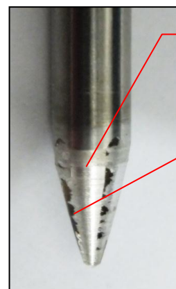
รูปที่ 4.11 ดอก HSS ขนาด 8 มม. ก่อนเจาะวัสดุ รูปที่ 4.12 ดอก HSS ขนาด 8 มม. หลังเจาะวัสดุ
