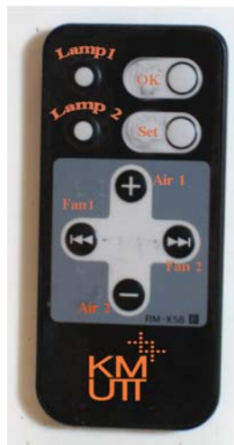
รูปที่ ก.5 ตัวรีโมทจะระบุการใช้งานของปุ่มที่จะควบคุมอุปกรณ์ไฟฟ้าในห้องเรียนตามเงื่อนไขที่กำหนดตามตารางในโปรแกรม
