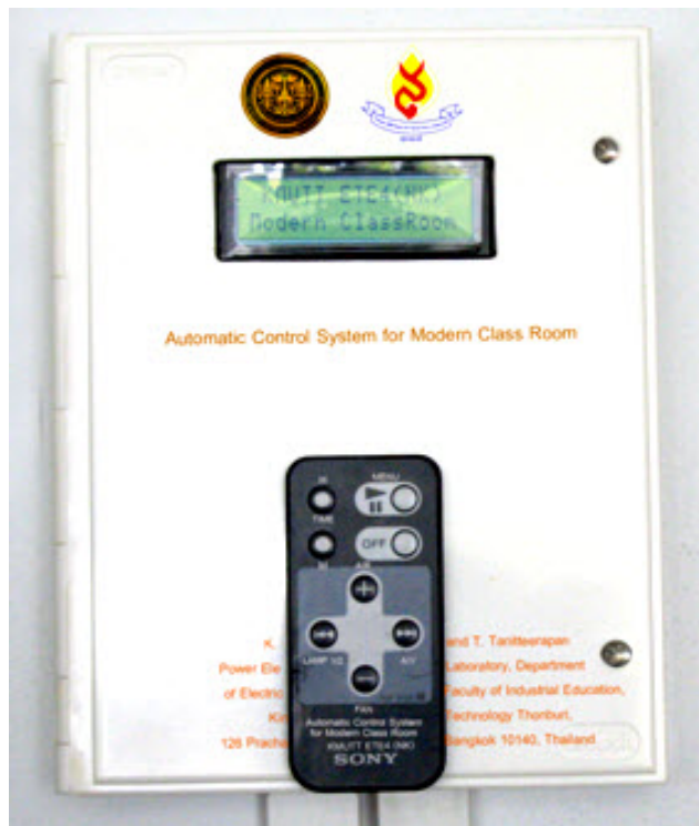
รูปที่ ก.1 ชุดเครื่องควบคุมอุปกรณ์ไฟฟ้าในห้องเรียน ระบบอัตโนมัติ พร้อมรีโมทคอนโทรล
