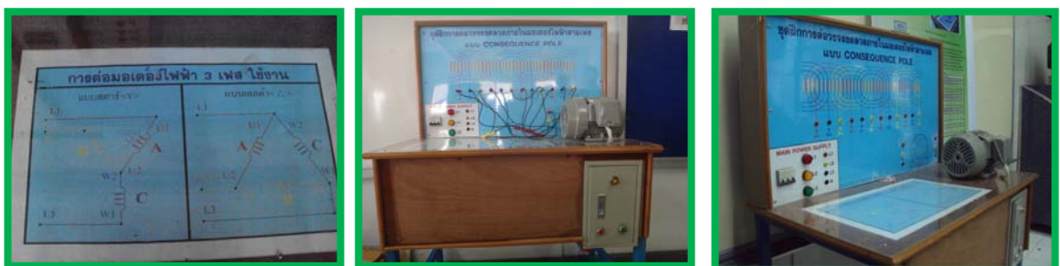
รูปที่ 4.6 แสดงวิธีการต่อแบบสตาร์ทและเคลด้า
