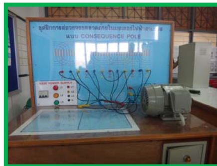
รูปที่ 4.5 การนำปลายสายของมอเตอร์ที่ไม่มีการต่อวงจรมาต่อเข้ากับแผงชุดฝึก
