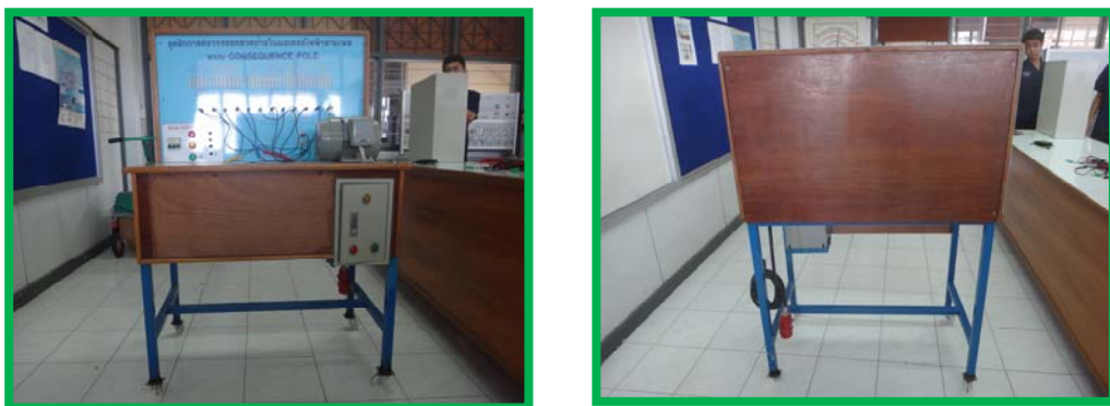
รูปที่ 3.4 ชุดทดลองการต่อวงจรขดลวดภายในมอเตอร์ไฟฟ้า 3 เฟส ด้านหน้าและด้านหลัง
