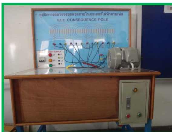
รูปที่ 3.6 ชุดทดลองการต่อวงจรขดลวดภายในมอเตอร์ไฟฟ้า 3 เฟส
