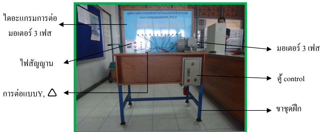
รูปที่ 3.3 ส่วนประกอบต่างๆชุดทดลองการต่อวงจรขดลวดภายในมอเตอร์ไฟฟ้า 3 เฟส
