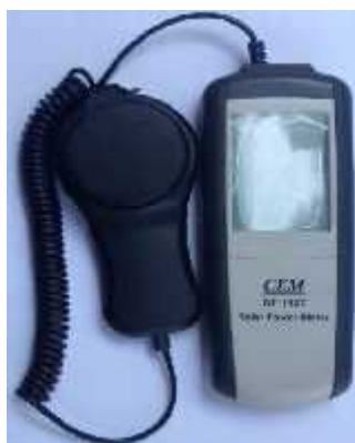
รูปที่ 3.6 เครื่องวัดความเข้มแสงอาทิตย์ ยี่ห้อ CEM รุ่น DT-1307
