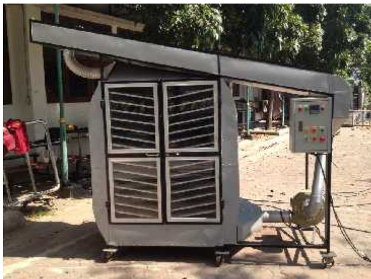
รูปที่ 3.21 เครื่องอบกระดาดใบสับปะรดพลังงานแสงอาทิตย์ร่วมกับฮีตเตอร์
