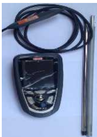
รูปที่ 3.7 เครื่องวัดความเร็วลม ยี่ห้อ kimo รุ่น AMI 300
