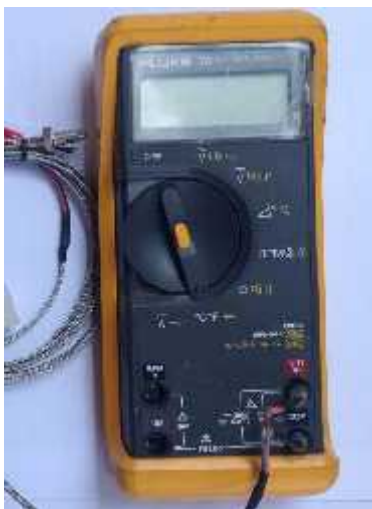
รูปที่ 3.3 เครื่องวัดอุณหภูมิ FLUKE 78
