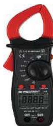
รูปที่ 3.8 เครื่องวัดกำลังไฟฟ้า BK Precision 325
