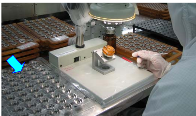
ภาพที่ 4.6 แสดงถาดบรรจุชิ้นงาน ในขั้นตอน การตรวจสอบน้ำยาบารีเออร์บนตัวฮับ และการตรวจสอบระนาบของตัวงาน
