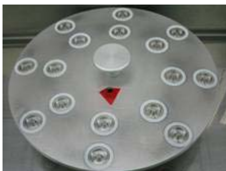
ภาพที่ 4.15 แสดงการเปลี่ยนแปลงถาดบรรจุชิ้นงานในขั้นตอนการปิดเชื่อมด้วยแสงเลเซอร์
