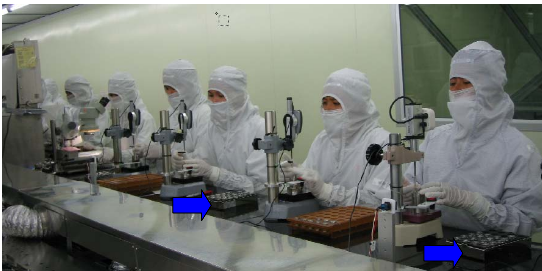
ภาพที่ 4.11 แสดงสภาพบรรจุชิ้นงานในขั้นตอนการตรวจสอบระนาบของตัวงานหลังการเปลี่ยนแปลง
