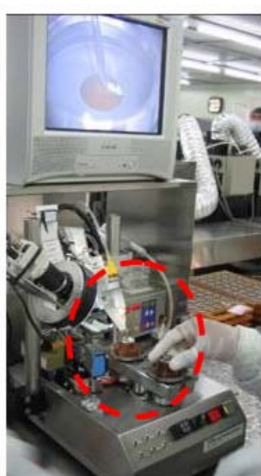
ภาพที่ 4.20 แสดงการปรับปรุงเวลาในขั้นตอนการหยอดกาว 353 เ็นดีบนตัวฮับ (Apply 353ND to Hub)
