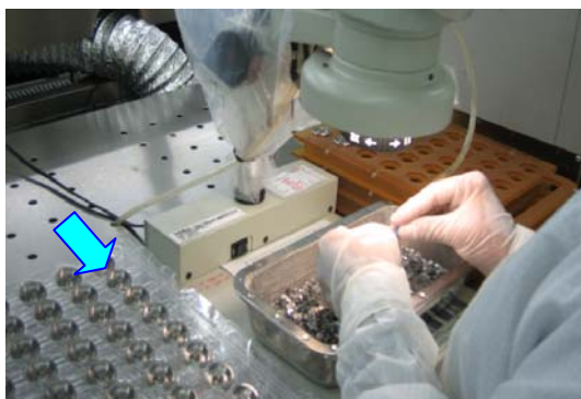
ภาพที่ 4.7 แสดงถาดบรรจุชิ้นงาน ในขั้นตอนการใส่ ฝาปิด และการตรวจปิดเชื่อมด้วยแสงเลเซอร์
