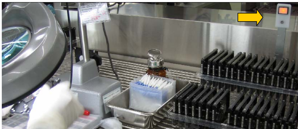
ภาพที่ 4.5 แสดงตำแหน่งติดตั้งสัญญาณไฟที่ขั้นตอนการตรวจสอบลักษณะภายนอกของชิ้นงานภายใต้กล้องกำลังขยาย 3 เท่า พร้อมกับการดูดฝุ่นผง
