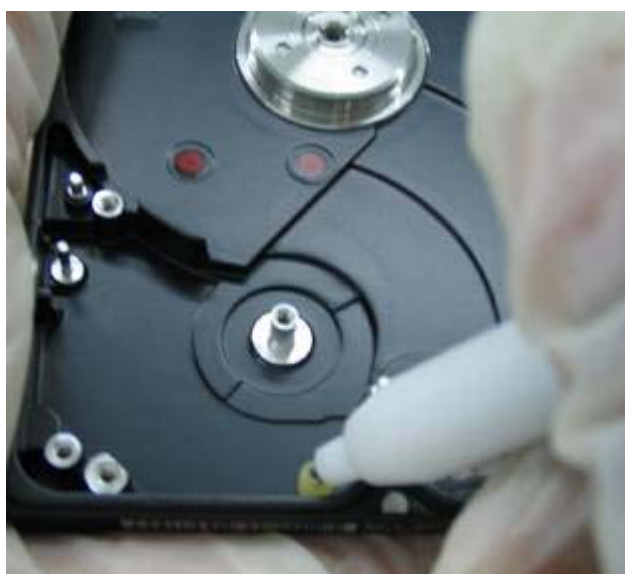
ภาพที่ 4.25 แสดงการปรับปรุงเวลาในขั้นตอนการประกอบ แคลช สตี้ป
