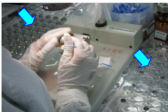
ภาพที่ 4.8 แสดงถาดบรรจุชิ้นงาน ในขั้นตอนการทำความสะอาดคราบน้ำมันภายใต้กล้อง กำลังขยาย 10 เท่า การตรวจสอบความสูงของแรมป์และการตรวจสอบ บาร์โค้ด
