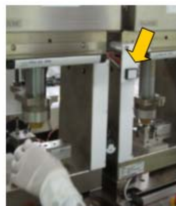
ภาพที่ 4.2 แสดงตำแหน่งติดตั้งสัญญาณไฟที่ขั้นตอน การหยอดน้ำยาบาร์เฮอร์ บน ตัวสลีฟ และขั้นตอน การสวมอัด ชาร์ฟ เข้ากับตัวฮับ
