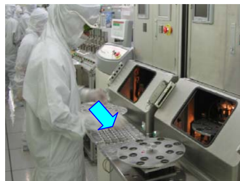
ภาพที่ 4.7 แสดงถาดบรรจุชิ้นงาน ในขั้นตอนการใส่ ฝาปิด และการตรวจปิดเชื่อมด้วยแสงเลเซอร์
