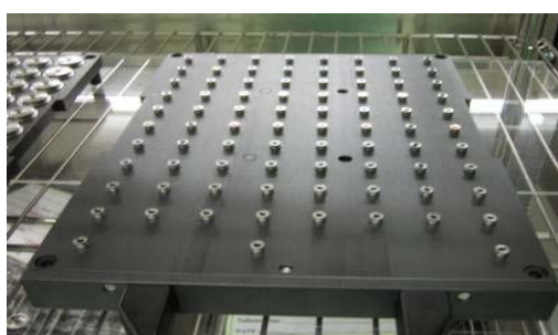
ภาพที่ 3.5 แสดงถาดบรรจุ สลึฟ และ ถาดบรรจุ ชาร์ฟ ที่ประกอบกับ ฮับ
