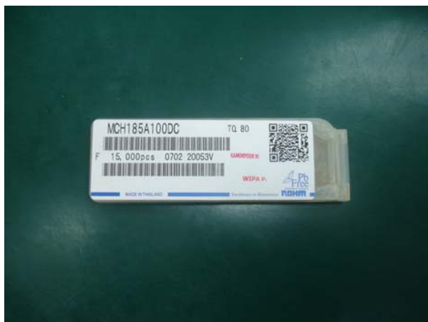
ภาพที่ 3.14 ลักษณะของการบรรจุผลิตภัณฑ์ลงในกล่องพลาสติก [Bulk case]
