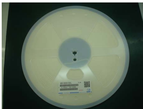
ภาพที่ 3.13 ลักษณะของการบรรจุผลิตภัณฑ์ลงในกระดาดแล้วม้วนเก็บ Spec L (Reel)
