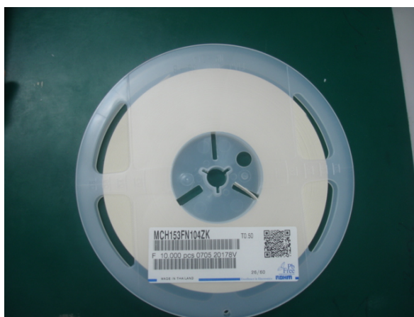
ภาพที่ 3.12 ลักษณะของการบรรจุผลิตภัณฑ์ลงในกระดาดแล้วม้วนเก็บ Spec K (Reel)
