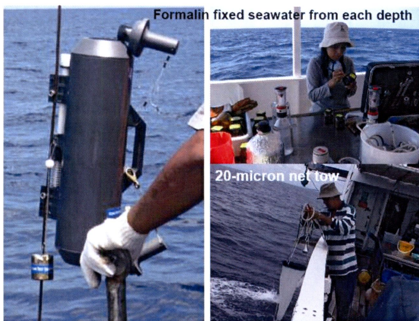
รูปที่ 2.4 การเก็บตัวอย่างโดยใช้ถุงแพลงตอนขนาด 20 \mu\text{m} เพื่อศึกษากีประกอบของแพลงตอนพืช และการเก็บตัวอย่าง 20 ลิตร เพื่อนำมากรองด้วยแผ่นกรองขนาด 0.7, 10, 20, และ 50 \mu\text{m} เพื่อทำ Fractionated Chlorophyll-a
