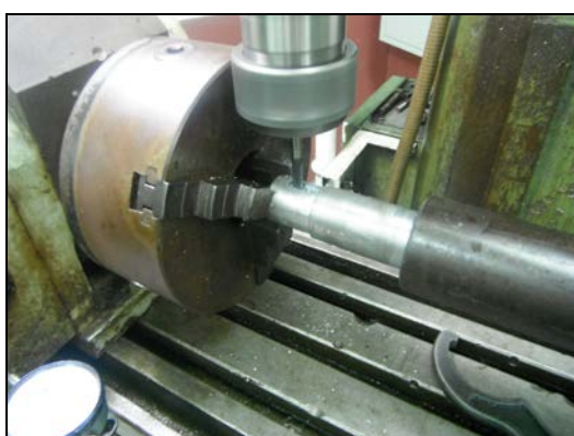
ภาพที่ 3-30 ทำร่องลิม
