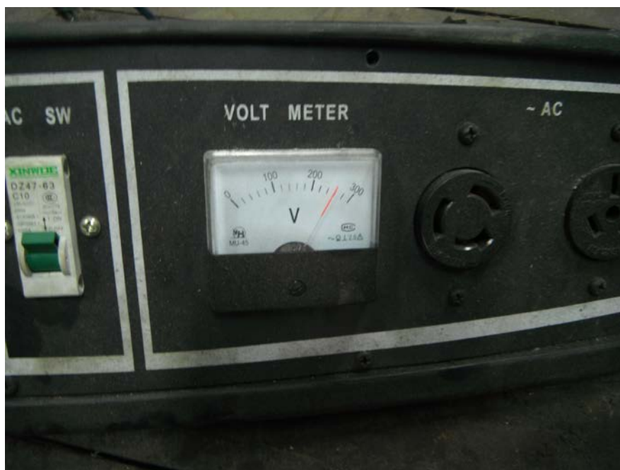
ภาพที่ 3-78 กระแสไฟที่ได้ 250 โวลท์
