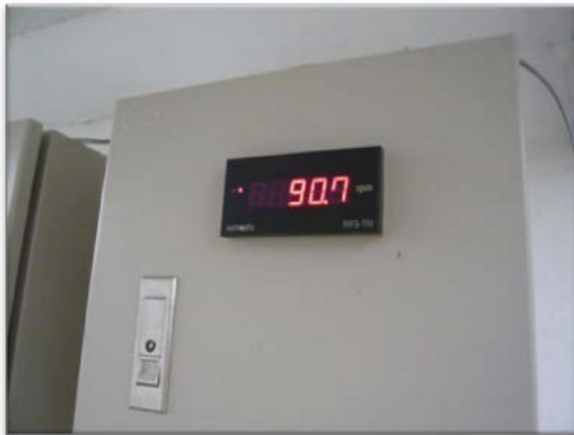
ภาพที่ 2-11 แสดงรอบของ Axial Flow เมื่อจมน้ำ และต่อกับระบบ
