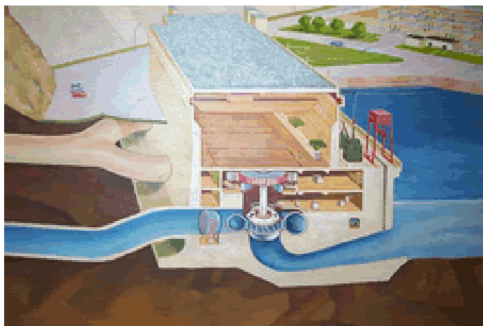
ภาพที่ 2-17 แสดงภาคตัดขวางของระบบโรงไฟฟ้าพลังงานน้ำ ที่มา (แผนพับเขื่อนสิริกิติ์. 2546)
