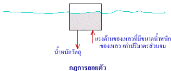
รูปที่ 2-32 แสดงกฎการลอยตัวของอาร์คิมิดีส
