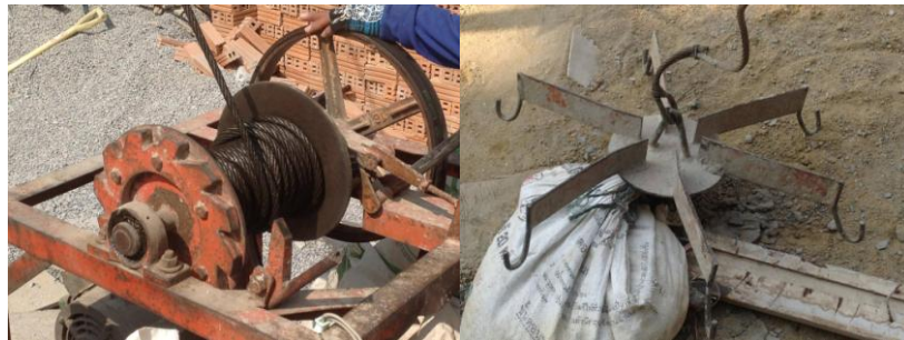
รูปที่ 4.9 อุปกรณ์ – เครื่องมือ ในการลำเลียงวัสดุต้องอยู่ในสภาพพร้อมใช้งาน
