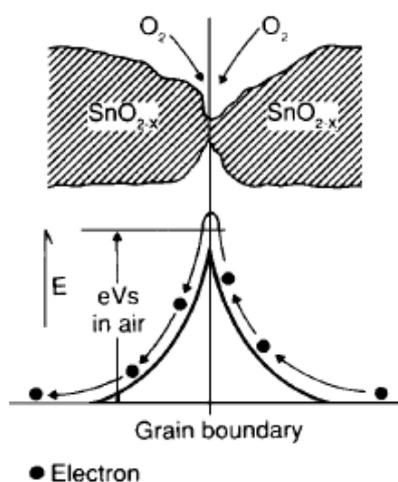
รูปที่ 2.1 โมเดลของศักย์ไฟฟ้าบริเวณรอยต่อ (ไม่มีก๊าซรีดิวซ์)
