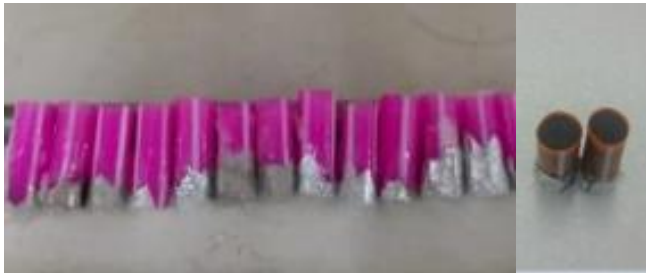
ปล่อยให้เทียนแข็งตัวแล้วดันเทียนออก ตามภาพคือ เทียนเปอร์ซัลเฟต และ เทียน เหล็กศูนย์
