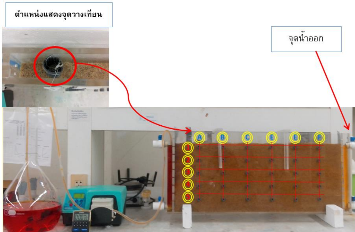
รูปที่ 12 แสดงการทำการทดลอง Transport experiment และแสดงตำแหน่งของ Persulfate candle
