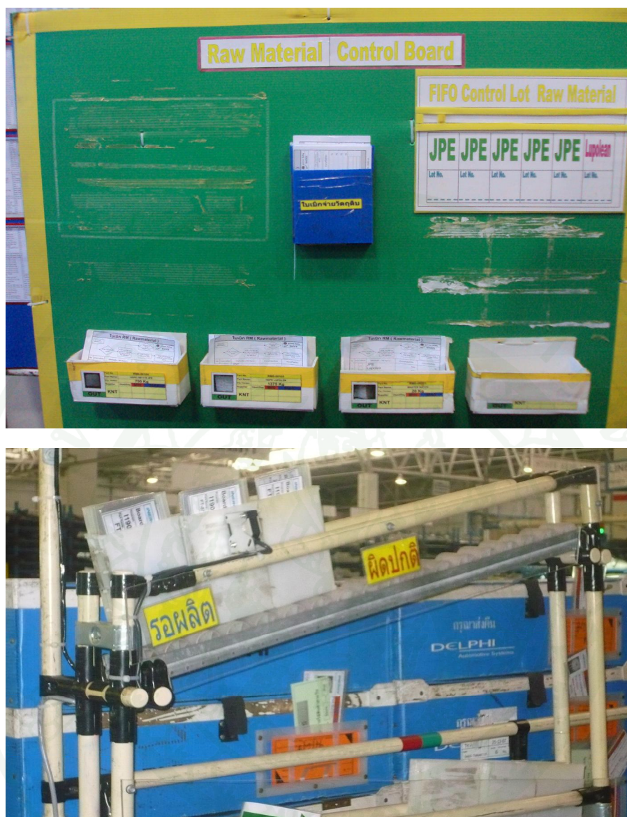
ภาพที่ 46 จัดทำกล่องคัมบัง (Kanban Box) สำหรับใส่จัดทำคัมบังเบิกวัตถุดิบและจัดทำรางคัมบัง (Kanban Chuter) สำหรับใส่คัมบังส่งผลิตจะวางไว้ในตำแหน่งท้ายกระบวนการเป่าถ้ำน้ำมัน
