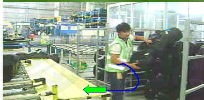
ภาพที่ 52 การขนย้าย หลังการปรับปรุง ที่มีโครงเหล็กสามารถเคลื่อนที่ได้เพื่อใส่ถึงน้ำมันออกจากเครื่อง Fluorination และกลับเข้าสู่ไลน์เพื่อประกอบชิ้นส่วนต่างๆ
