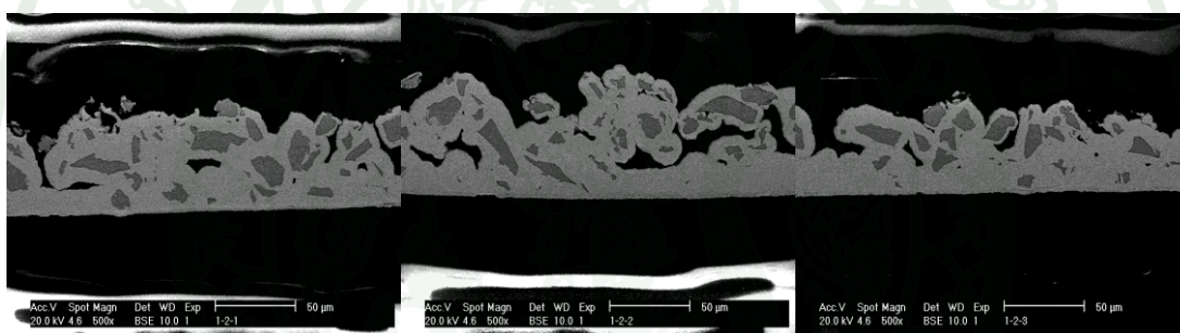
ภาพผนวกที่ 14 ภาพตัดขวางของฟิล์มวัสดุประกอบนิกเกิลไทเทเนียมที่ปลูกฟิล์มบนวัสดุพื้นอินเดียมทินออกไซด์ด้วยความหนาแน่นกระแส 200 \text{ mA/cm}^2 สำหรับผงไทเทเนียมขนาด -22 ไมครอน ที่ปริมาณผงไทเทเนียม 0.6 กรัมต่อลิตร
