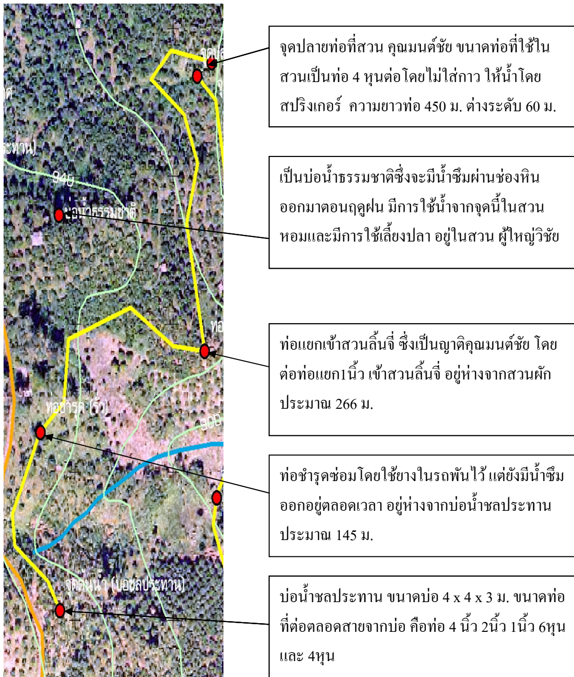
รูปที่ 6.4 ผลการสำรวจท่อน้ำจากระบบบ่อน้ำของชลประทานสายที่ 2 นายมนต์ชัย ถนนมกิจดี
