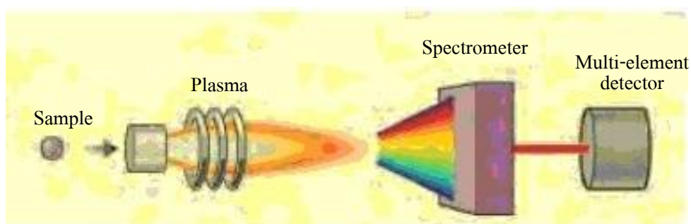
รูปที่ 2.32 แผนผังของ ICP-AES [38]
