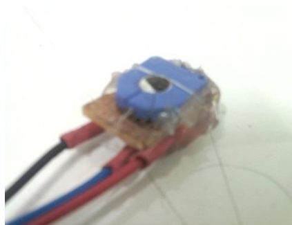
รูปที่ 5.20 การเชื่อมต่อ Potentiometer
