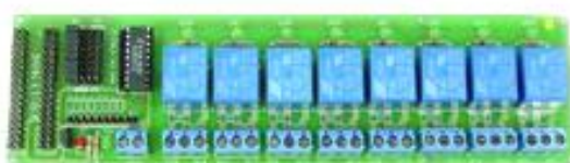
รูปที่ 5.11 RELAY ETT-REL8 12V อุปกรณ์ Trig สวิตช์ SMC ZM101H
