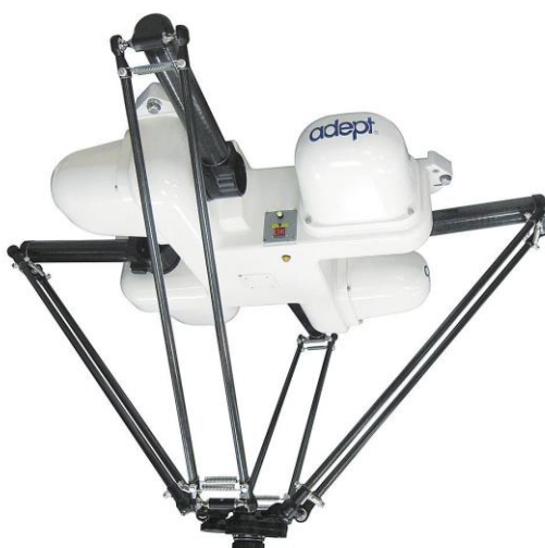
รูปที่ 3.2 แขนกลแบบกลไกขนาน ( Parallel Robot )
