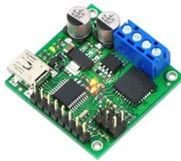
รูปที่ 5.16 บอร์ด Motor Control ให้เป็น บอร์ด Polulu รุ่น Jrk 21v3
