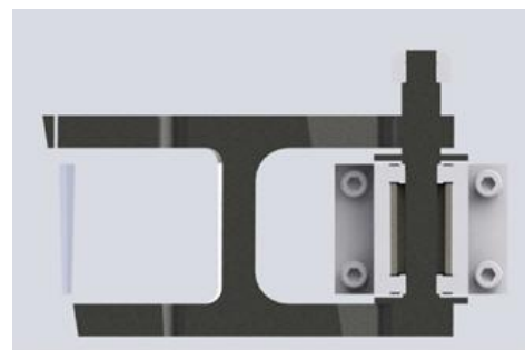
รูปที่ 7.13 เปลี่ยน Bearing เป็นแบบ High Precision และยึดแบบ Bearing คู่
