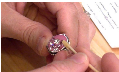
รูปที่ 4.3 การวางพลอยลงบนตัวเรือน
