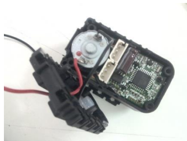
รูปที่ 5.18 การปรับปรุงมอเตอร์เพื่อให้มอเตอร์ถูกควบคุมด้วยบอร์ด Polulu
