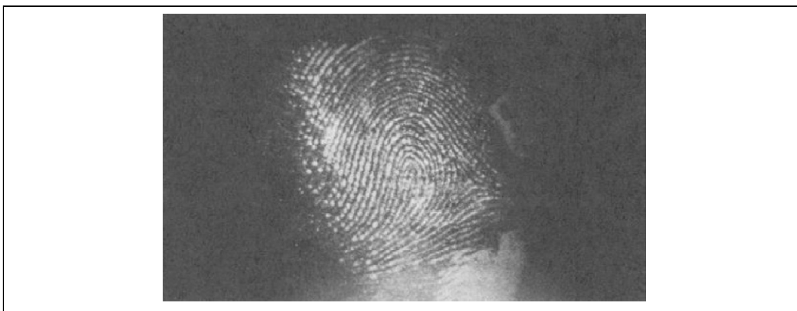
รูปที่ 1.3 แสดงภาพลายนิ้วมือแฝงบนแก้วเมื่อปิดด้วยผงฟู้นแม่เหล็ก FMP 01 ที่ข้อมด้วยสารเรืองแสง Nile blue A perchlorate ภายใตแสงเลเซอร์สีแดง [3]
