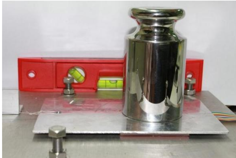
รูปที่ 3.10 ขั้นตอนวัดค่าความจุไฟฟ้าร่วมกับน้ำหนักกดทับ
