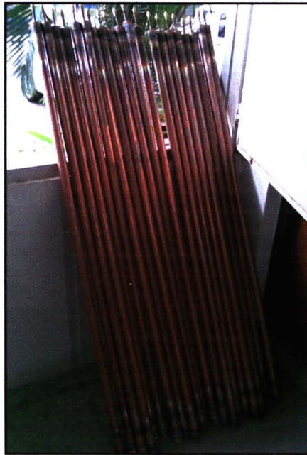
รูป 3.6 ท่อทองแดงที่เชื่อมฝาปิดหัวท้ายและพร้อมเติมสารทำงาน
