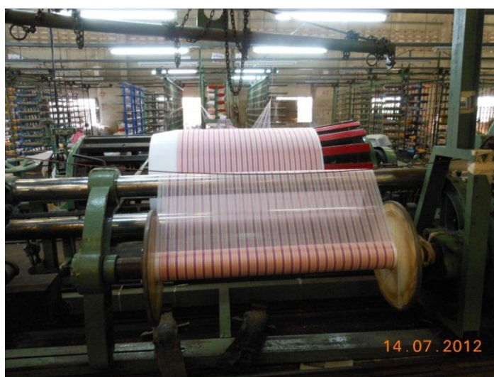
ภาพที่ 2.2 ลักษณะเส้นด้ายยืนบนเครื่องทอผ้า
