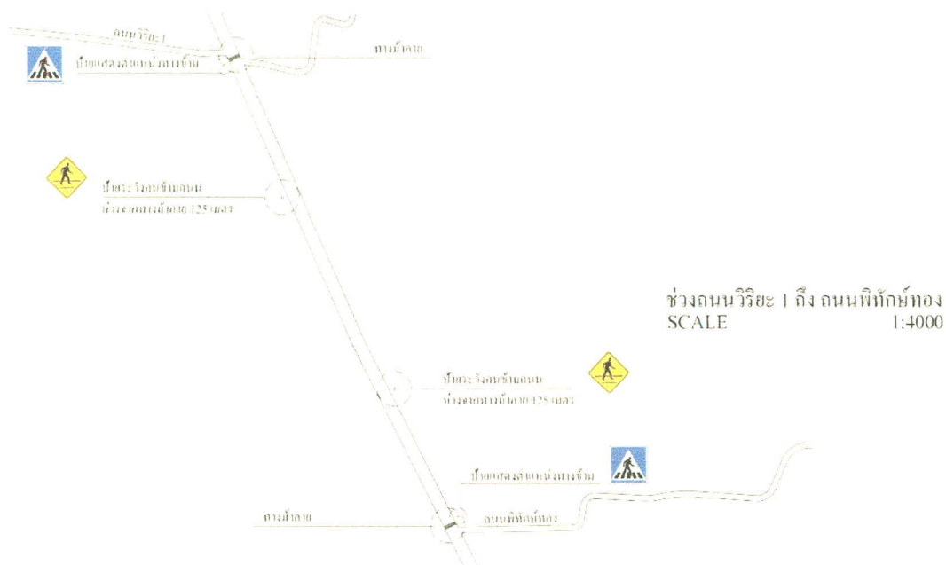
รูปที่ 5-10 การติดตั้งป้ายจราจรและทางม้าลาย ช่วงถนนวิริยะ 1 - ถนนพิทักษ์ทอง
