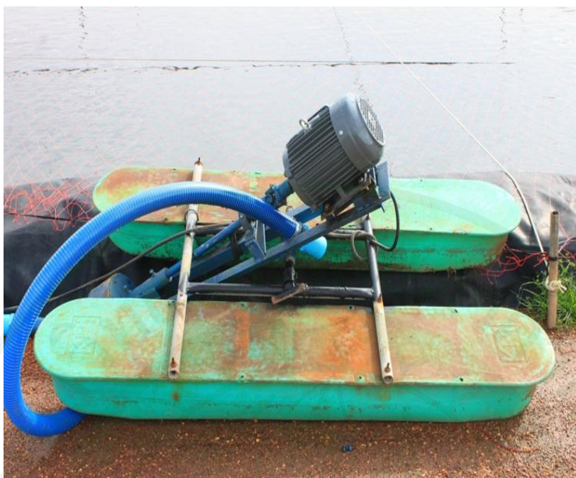
ภาพที่ 5 มอเตอร์ไฟฟ้าขนาด 3 แรงม้าประกอบเข้ากับทุ่น KPI
