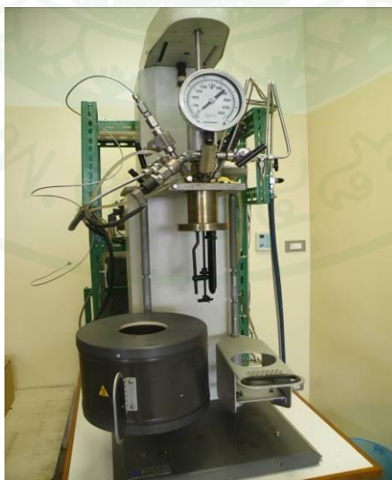
ภาพที่ 7 ปฏิกรณ์สังเคราะห์น้ำมันชีวมวล
