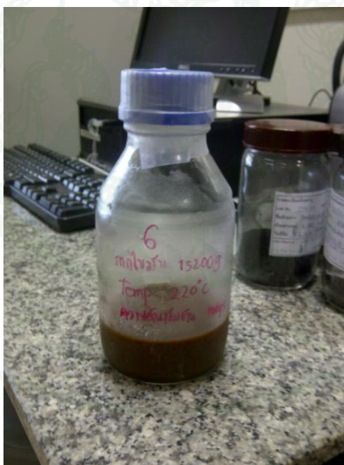
(ข) ผลผลิตน้ำมันชีวมวลที่อุณหภูมิ 220 องศาเซลเซียส
