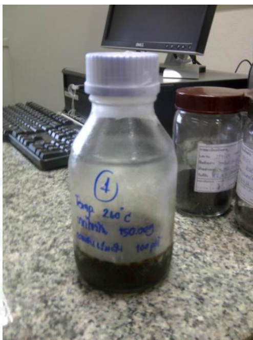
(จ) ผลผลิตน้ำมันชีวมวลที่อุณหภูมิ 260 องศาเซลเซียส
