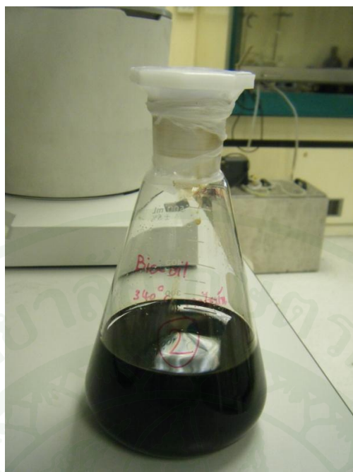
(ค) ผลผลิตน้ำมันชีวมวลที่อุณหภูมิ 340 องศาเซลเซียส
