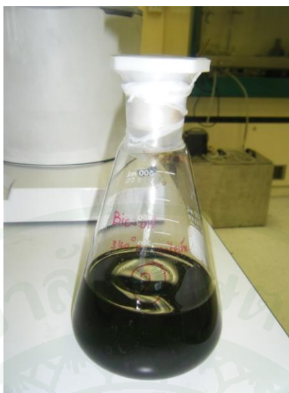
(ก) ผลผลิตน้ำมันชีวมวลที่อุณหภูมิ 420 องศาเซลเซียส
