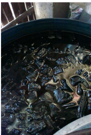
ภาพที่ 4.6 การดูดซับสิ่งสกปรกในน้ำส้มควันไม้ด้วยเศษถ่านไม้
