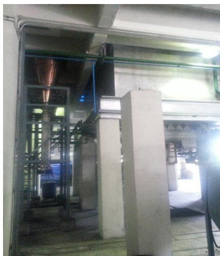
ภาพที่ 4.25 เตาปฏิกริยาในการผลิตก๊าซชีวมวลจากไม้กระถินยักษ์ เพื่อผลิตกระแสไฟฟ้า ของบริษัท A (นามสมมติ)
