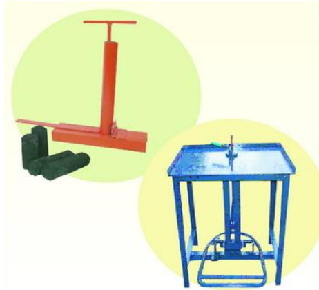
ภาพที่ 2.16 เครื่องตัดเชื้อเพลิงแท่งชนิดใช้แรงคน
