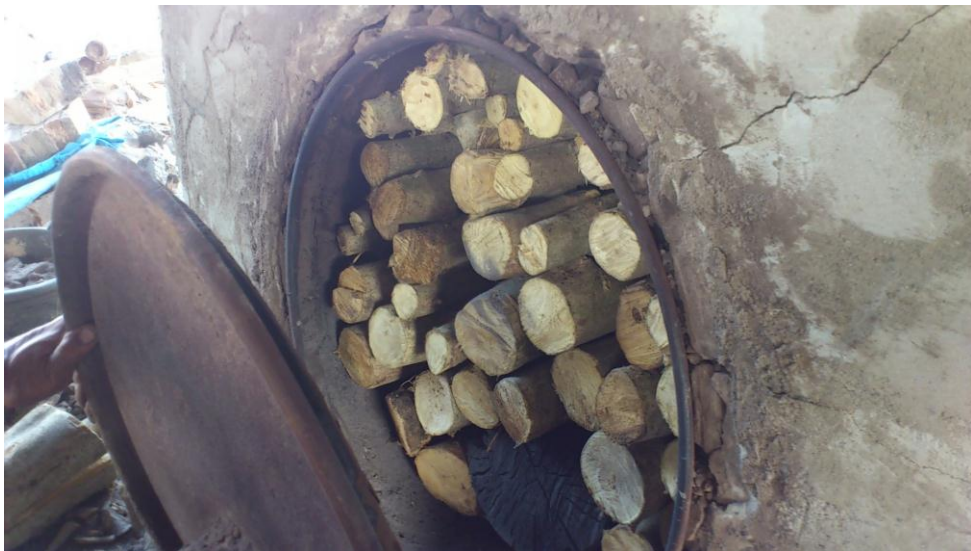
ภาพที่ 4.4 การบรรจุเศษไม้ เพื่อเผาทำถ่านไม้ด้วยเตาเผาถ่าน 200 ลิตรแบบนอน
