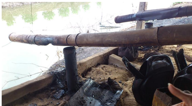
ภาพที่ 4.5 ท่อไม้ไผ่เพื่อเก็บรวบรวมน้ำส้มควันไม้
