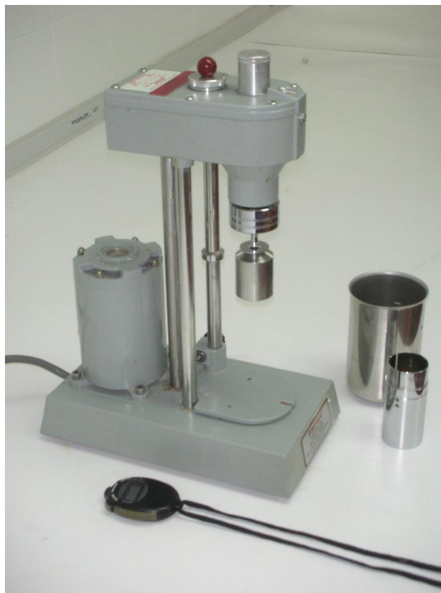
รูปที่ 3.3 เครื่องวัดความหนืด Fann Viscometer รุ่น 35SA
