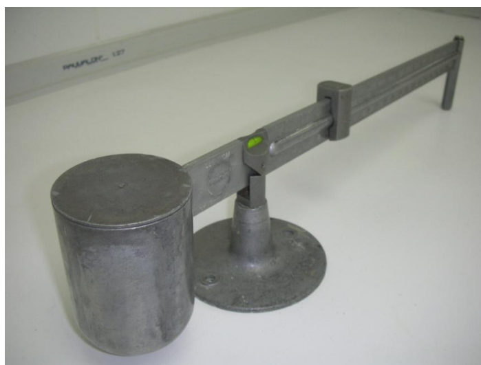
รูปที่ 3.2 API Mud balance ที่ใช้วัดความหนาแน่นของน้ำโคลนตัวอย่าง
