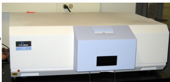
รูปที่ 1.3 เครื่องฟลูออโรมิเตอร์ชนิดใช้เกรตติง
