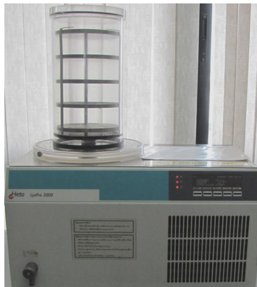
ภาพที่ 3.4 กระบวนการทำแห้งแบบแช่เยือกแข็ง (Freeze drying)
