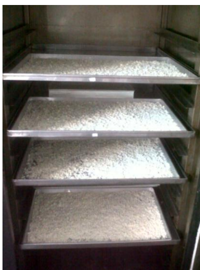
ภาพที่ 3.5 กระบวนการทำแห้งแบบตู้อบลมร้อนแบบถาด (Tray drying)
