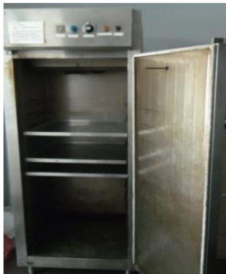
ภาพที่ 3.5 กระบวนการทำแห้งแบบตู้อบลมร้อนแบบถาด (Tray drying)
