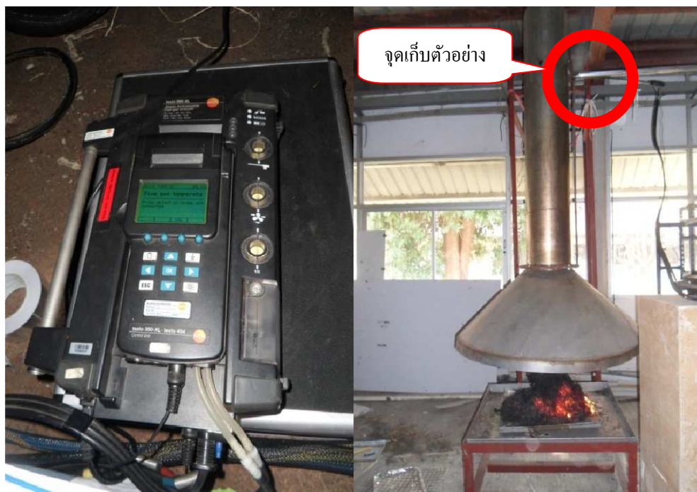
รูปที่ 5-2 การเก็บตัวอย่างแก๊สใช้ Flue Gas Analyzer
