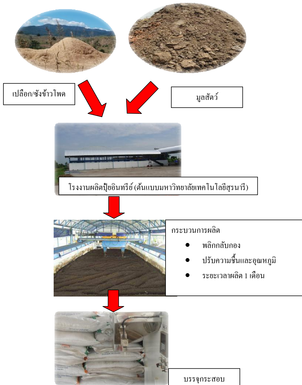
รูปที่ 3-22 ขั้นตอนการผลิตปุ๋ยอินทรีย์จากชีวมวลข้าวโพดด้วยโรงงานปุ๋ยอินทรีย์ของมทส.
