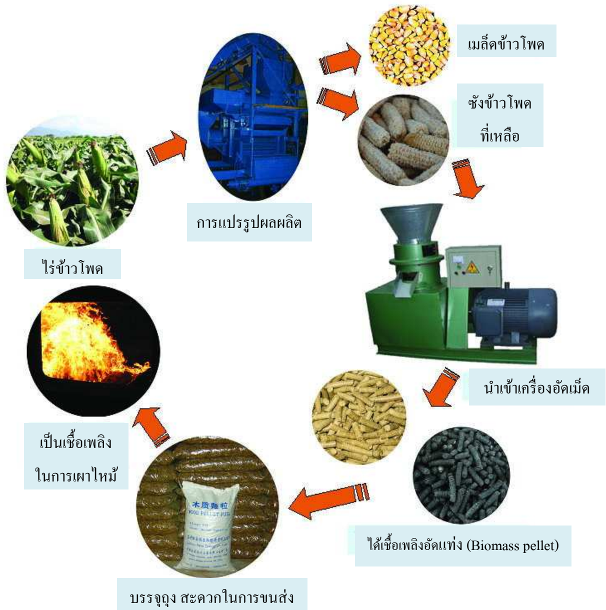
รูปที่ 3-52 กระบวนการผลิตเชื้อเพลิงอัดแท่ง
