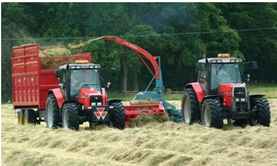
รูปที่ 3-40 รถเก็บเกี่ยวแบบ Forage Chopper [23]
