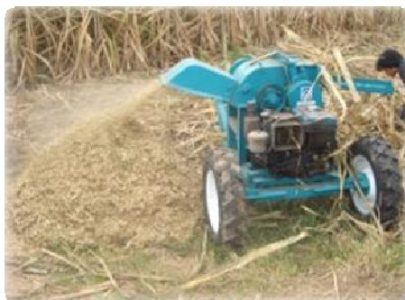
รูปที่ 3-74 เครื่องสับใบอ้อยติดเครื่องยนต์เบนซินขนาด 5.5 HP กำลังการผลิต 1 ตัน/ช.ม. ราคา ประมาณ 30,000 – 50,000 บาท [44]
