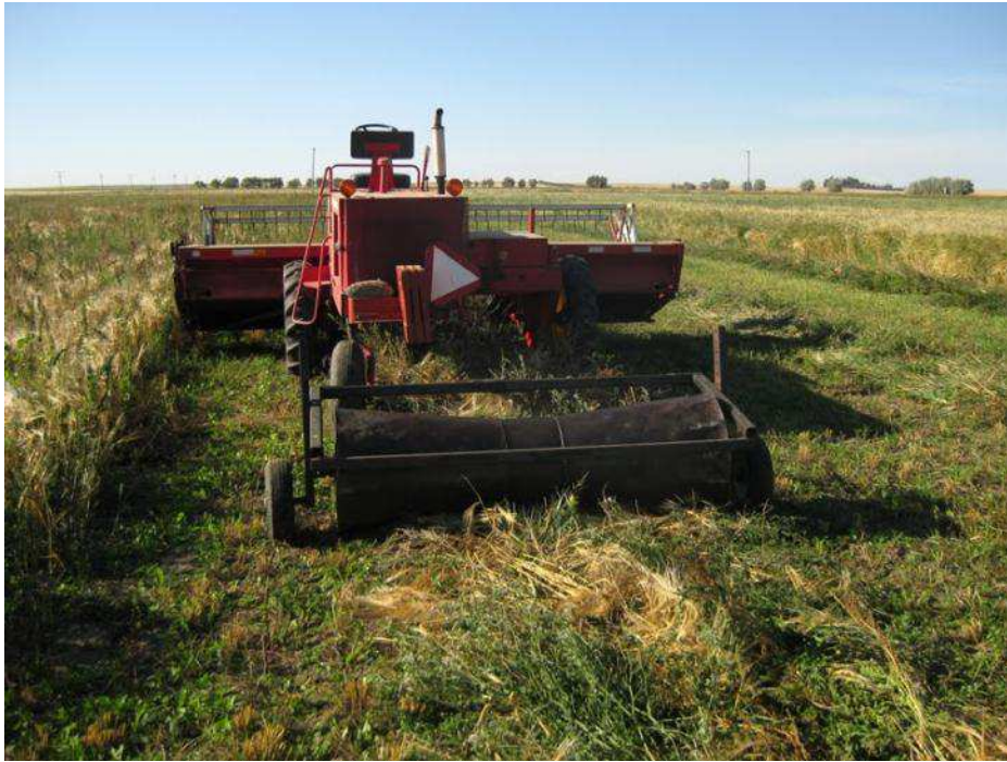
รูปที่ 3-39 รถเก็บเกี่ยวแบบ Swather [22]
