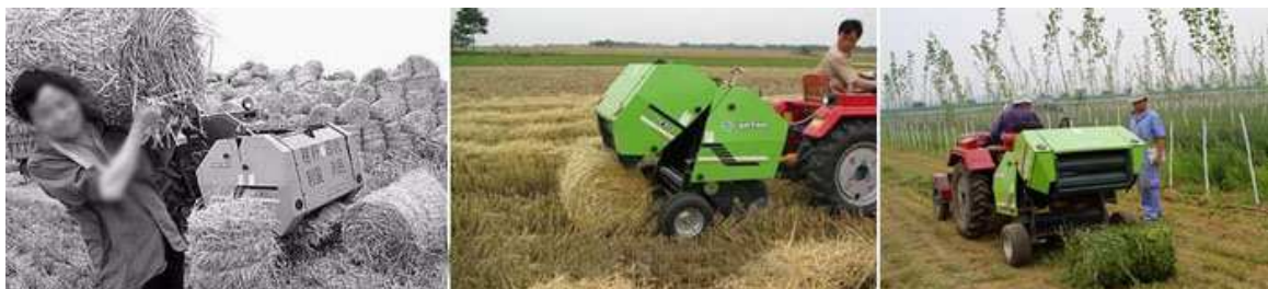
รูปที่3-69เครื่องอัดก้อนแบบม้วนจากประเทศจีน[42]
