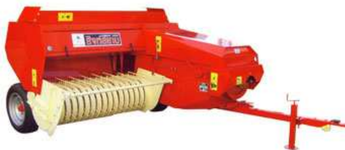
รูปที่ 3-67 แสดงเครื่องอัดฟาง หญ้าแห้ง และใบอ้อย “สิงห์สยาม” [38]
