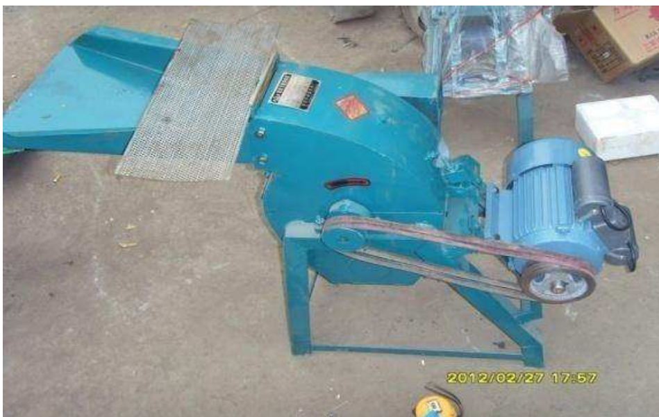
รูปที่ 3-77 เครื่องบดละเอียดขูดและใบอ้อย [43]
