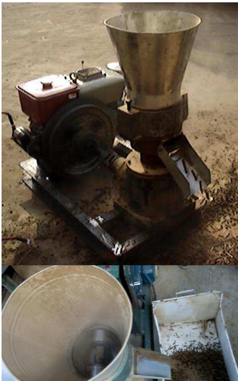
รูปที่ 3-80 เครื่องอัดใบอ้อยให้เป็นแท่งเชื้อเพลิงแข็ง ขนาดเล็กกำลังการผลิตประมาณ 350 – 450 กิโลกรัม / ชั่วโมง รุ่นที่ใช้เครื่องยนต์ 22-24 HP และรุ่นที่ใช้มอเตอร์ 15 kW
