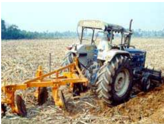
รูปที่ 2-21 แสดงเครื่องสับใบและกลบเศษซากอ้อย ประดิษฐ์โดยกรมวิชาการเกษตร
