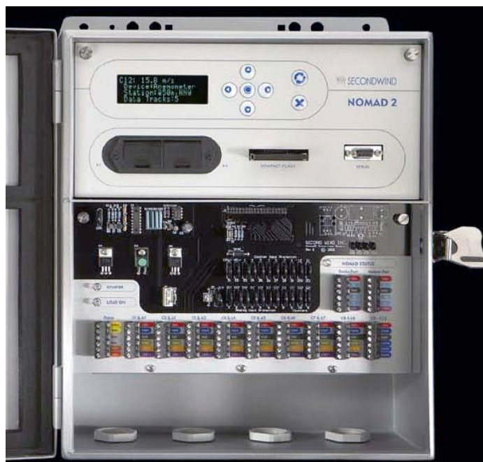
รูปที่ ก.4 เครื่องบันทึกข้อมูลอัตโนมัติ พร้อมทั้งระบบระบบส่งข้อมูลผ่านระบบ GSM
