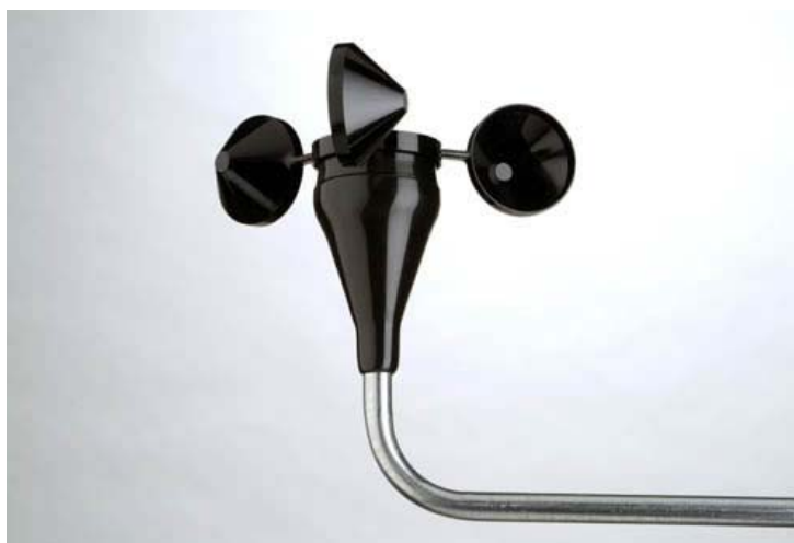
รูปที่ ก.1 แอนนิโมมิเตอร์แบบปรับแต่งแล้วที่ใช้ในการวัดความเร็วลมทั้ง 4 ระดับ
